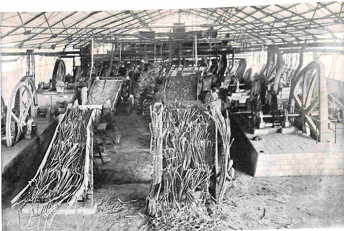
FABRICATIE VAN RIETSUIKER OP JAVA. HET SUIKERRIET WORDT DOOR CARRIERS NAAR DE MOLENS GEVOERD.
