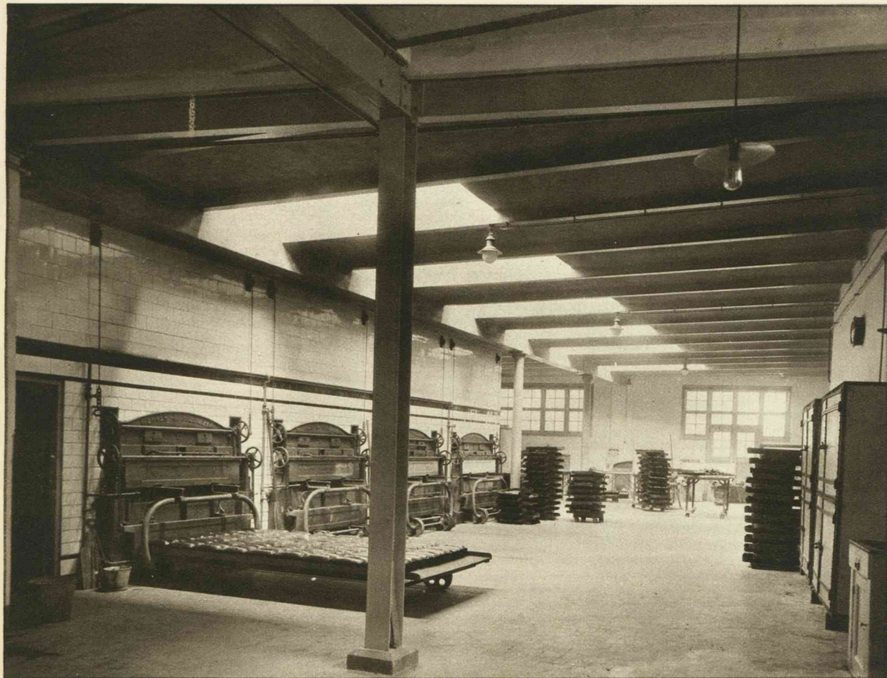
Gedeelte werkplaats met 8 van de 16 ovens. Deze ovens kunnen 24.000 brooden per etmaal bakken.
